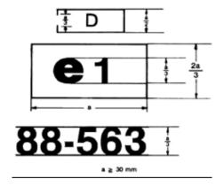
Die Verbindungseinrichtung mit dem angegebenen EG-Bauteil-Typgenehmigungszeichen ist eine dynamisch geprüfte (D) Verbindungseinrichtung, für die in Deutschland (e1) unter der Nummer 88–563 eine EG-Typgenehmigung erteilt wurde.
